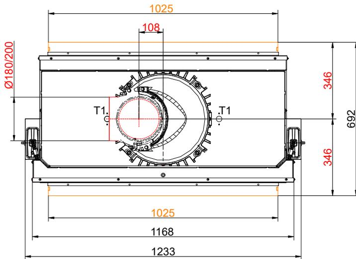
... Schiebetür/Kipptür mit Anbaurahmen und Wärmetauscherringe Guss + Gusskuppel
