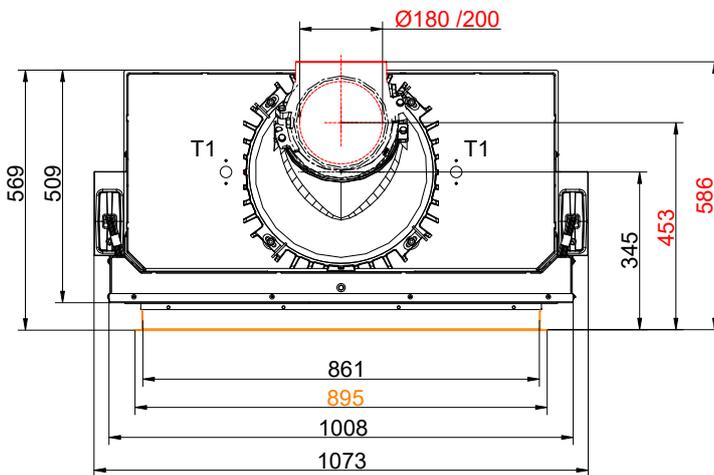
... Blendrahmen und Wärmetauscherringe Guss + Gusskuppel
