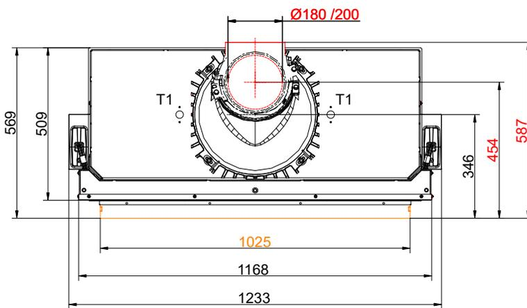
... Anbaurahmen und Wärmetauscherringe Guss + Gusskuppel
